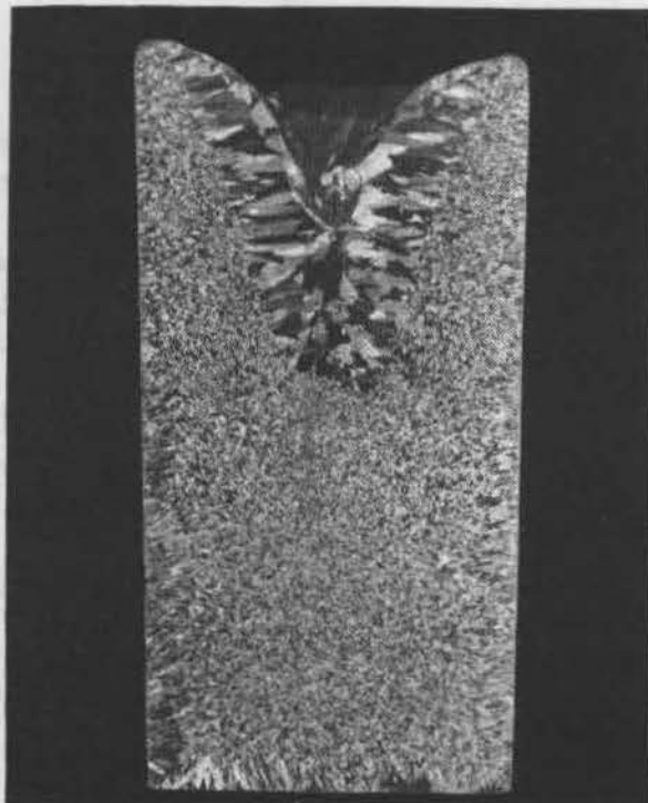
2c) Al - Vazamento através de canal alimentador refrigerado a água.
