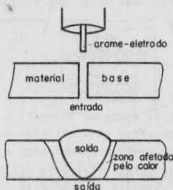
Fig. 1 Entrada e saída do processo de soldagem.
