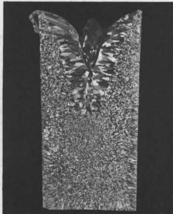
2d) Al 4,75% Cu - Vazamento através de canal alimentador refrigerado a água.
