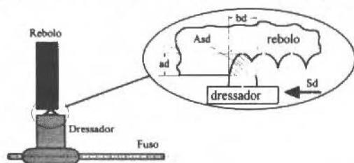
Fig. 3 Forma Esquemática da Operação de Dressagem de Rebolos Convencionais com Dressador do Tipo Ponta Única
