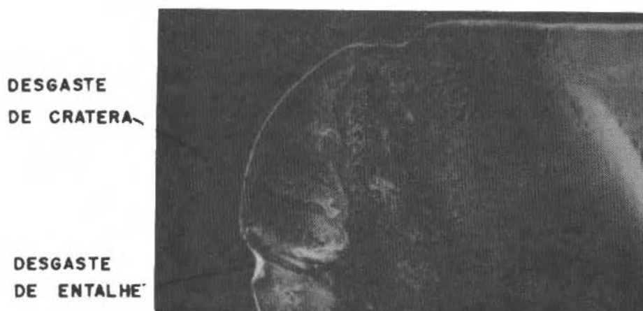
b. Torneamento de aços dúteis (SAE/ABNT 1045) - Metal duro P20
