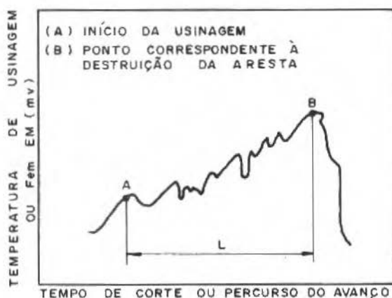
Fig. 4 Registro típico da temperatura de usinagem obtido durante o ensaio V_{LF}
