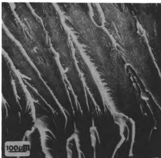
Figura 10. Marcas de rasgamento desenvolvidas na junção de dois planos em função da plastificação do polímero. ( $T = 60^{\circ}\text{C}$ , 4 dias).
