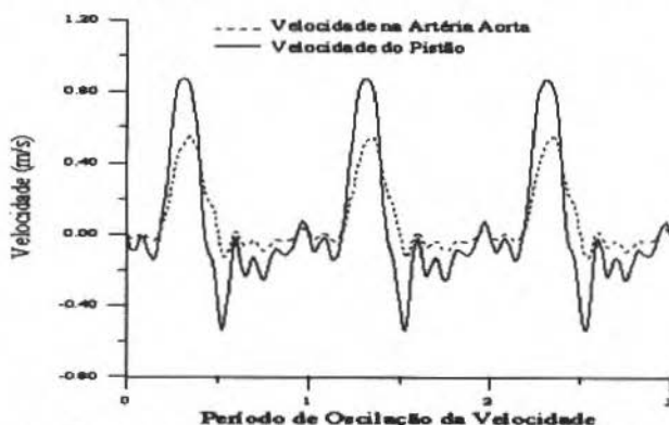
Fig. 3 Gráfico do pulso de velocidade da artéria aorta e o pulso de velocidade de pistão necessário para reproduzi-lo
