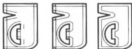
Fig. 3 Definindo o "Offset" do Contorno Diretamente a Partir do Contorno da Reentrância, Caso com Várias Auto-Intersecções.
