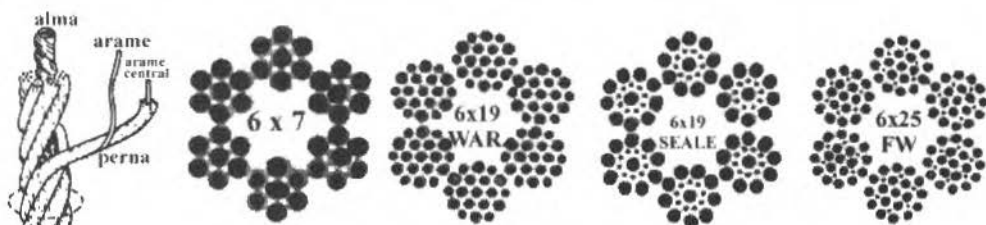
Fig. 1. Elementos de um cabos de aço e construções mais freqüentes
