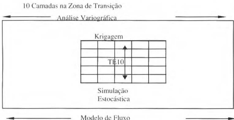
Fig. 3 Esquema utilizado na fase de estimativa por krigagem e de simulações estocásticas, das permeabilidades horizontal e vertical na direção horizontal, na área em torno do poço TE10.
